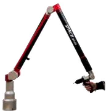
Рис. 1. Измерительная рука (слева) и лазерная сканирующая головка (справа)
