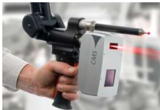
Рис. 1. Измерительная рука (слева) и лазерная сканирующая головка (справа)
